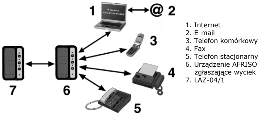
Rys. 5. Detektor wycieku LAZ-04/1 z systemem firmy Afriso do zdalnej sygnalizacji
